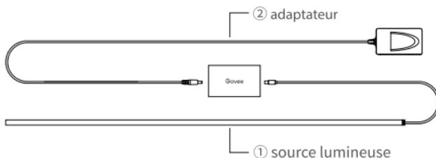
Le produit se compose de deux parties : (1) une source lumineuse et (2) un adaptateur. Si vous retirez le connecteur de sortie de l'adaptateur, vous pouvez facilement retirer la source lumineuse ou l'adaptateur
