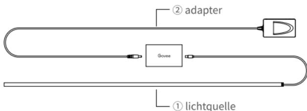
Das Produkt ist in zwei Teile unterteilt: (1) einer Lichtquelle und (2) einem Adapter. Durch Abnehmen des Ausgangsanschlusses des Adapters können Sie die Lichtquelle oder den Adapter leicht entfernen.
