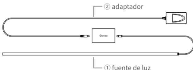
El producto se divide en dos partes: (1) una fuente de luz y (2) un adaptador. Al separar el terminal de salida del adaptador, se pueden retirar fácilmente la fuente de luz y el adaptador.
