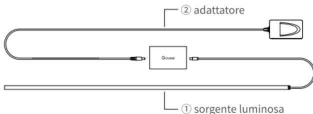
Il prodotto è diviso in due parti: (1) una sorgente luminosa e (2) un adattatore. Staccando il terminale di uscita dell'adattatore, puoi rimuovere facilmente la sorgente luminosa o l'adattatore.
